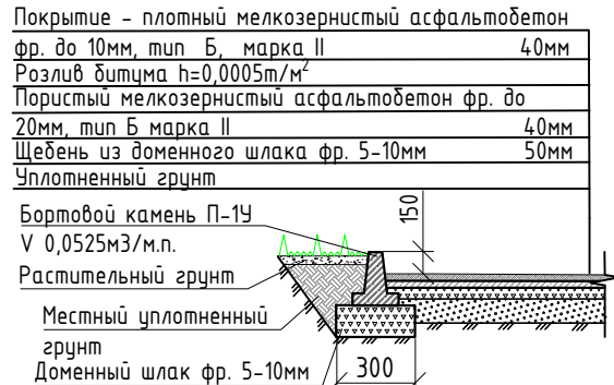
КОНСТРУКЦИЯ ДОРОЖНОЙ ОДЕЖДЫ ПРОЕЗДОВ НА СУЩЕСТВУЮЩЕМ ОСНОВАНИИ ТИП 2
