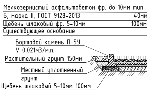
КОНСТРУКЦИЯ ПОКРЫТИЯ СУЩЕСТВУЮЩИХ ТРОТУАРОВ ТИП 3
